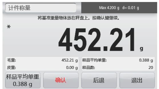
主屏幕显示计件结果，基准为天平计算得出的样品平均单重。
