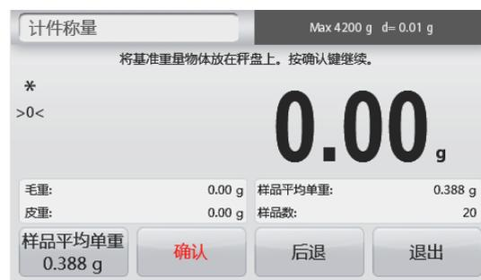
放置基准重量的物品到秤盘上，按**确定**，屏幕显示件数。
