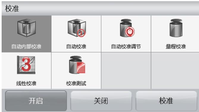
天平开始自动内部校准。跟随屏幕指示清空秤盘，等待校准完成。
