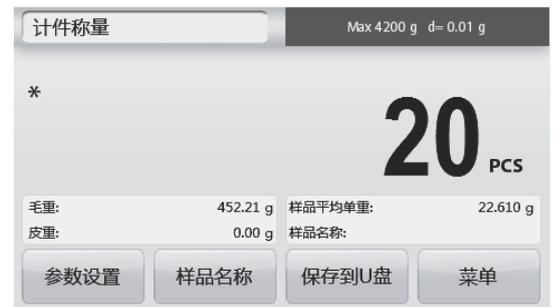
**自动优化单重：** 设置为**开启**时，将在添加样品的时候自动重新计算平均单件重量。从而提高计件精度。
