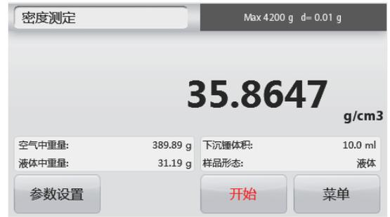
**4.5.5 用油测试多孔材料的密度**
