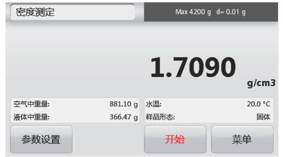
当测试完毕，屏幕上采以单位g/cm<sup>3</sup>显示样品密度值。触摸**开始**重新开始测定。
