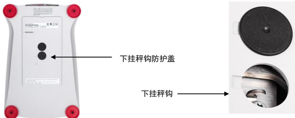
天平可以使用实验室支撑台或其他任何方便的方法进行支撑。确保天平调节水平而且安装地牢靠。连接电源，然后使用线或金属丝连接下挂秤钩和样品。
