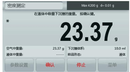
测试结束后，液体样品的密度在屏幕上以g/cm<sup>3</sup>为单位显示（以及空气中重量和液体中重量）。
