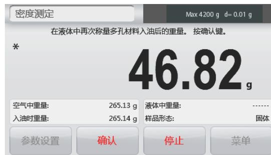
当测试结束后，样品的密度上以 $\text{g/cm}^3$ 为单位显示（以及空气中重量、浸油时重量和液体中重量）。
