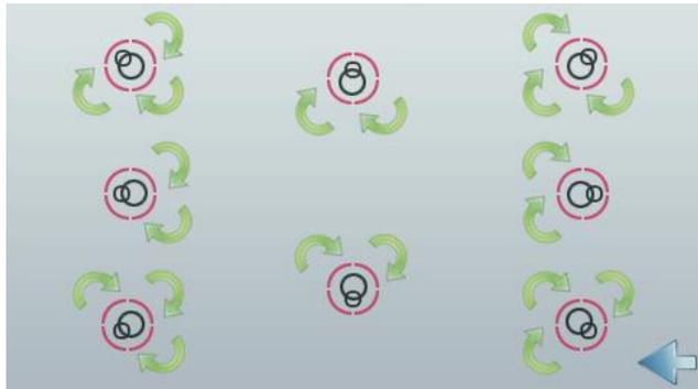
根据水平泡可能的位置，按照箭头方向调节水平调脚，直到水平泡在圆圈的中央。
