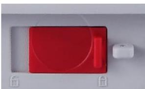
说明：位于天平基座后部的 LFT 开关必须位于锁定位置才可把贸易结算设置为开启。基座后部的 LFT 开关必须位于解锁位置才可把贸易结算设置为关闭。参见第 6 章节。LFT 开关开启时基本称量的主屏幕。
